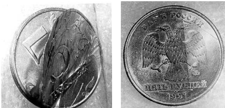
Рис. 6. Полное (слева) и частичное (справа) отслоение плакирующего покрытия
