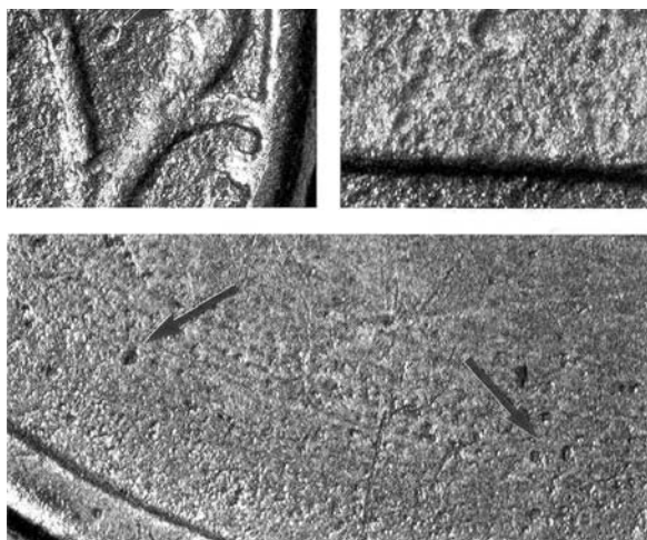
Рис. 29. Раковины на поддельных монетах, изготовленных способом литья
