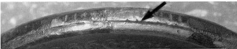
Рис. 32. Место соединения двух частей поддельной монеты, изготовленной способом гальванотехники
