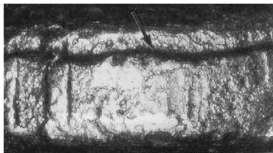
Рис. 30. След соединения двух половинок литейной формы на гурте поддельной монеты, изготовленной способом литья
