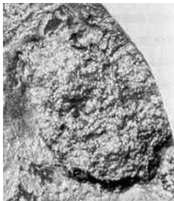
Рис. 27. Изменение в структуре металла под воздействием высоких температур
