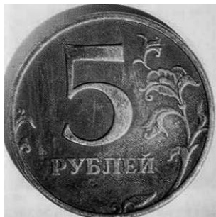
Рис. 21. Потемнение мельхиорового покрытия монеты под воздействием сероводорода
