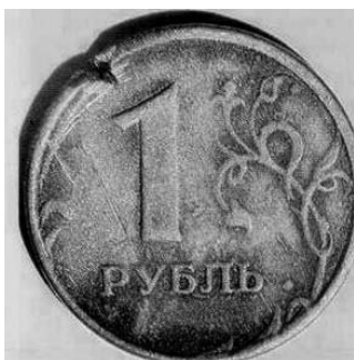
Рис. 22. Слой меди на поверхности монеты под воздействием нейзильбера
