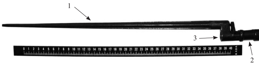
Русский игольчатый штык к винтовке системы Мосина 1 – штык; 2 – трубка; 3 – шейка штыка
