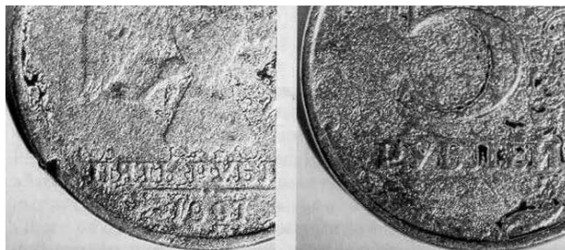
Рис. 20. Изменение вида поверхности монет в результате травления кислотами
