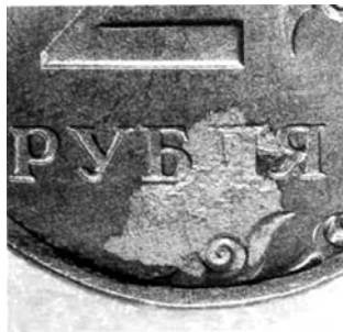
Рис. 13. Вмятина после удаления заштампованной грязи
