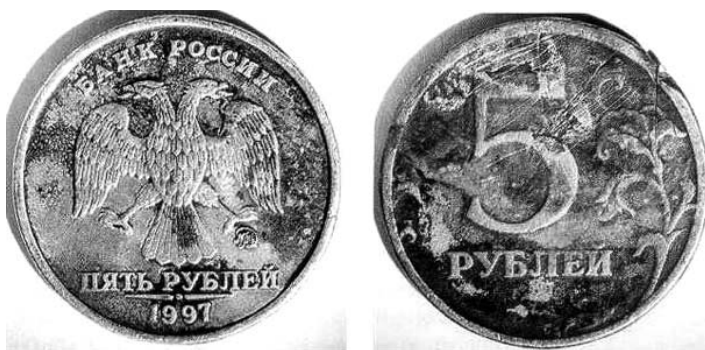
Рис. 25. Изменение цвета поверхности монет в результате воздействия высоких температур
