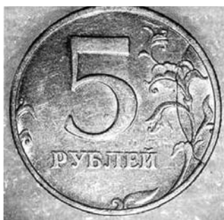
Рис. 11. Сдвиг частей треснутого штампа
